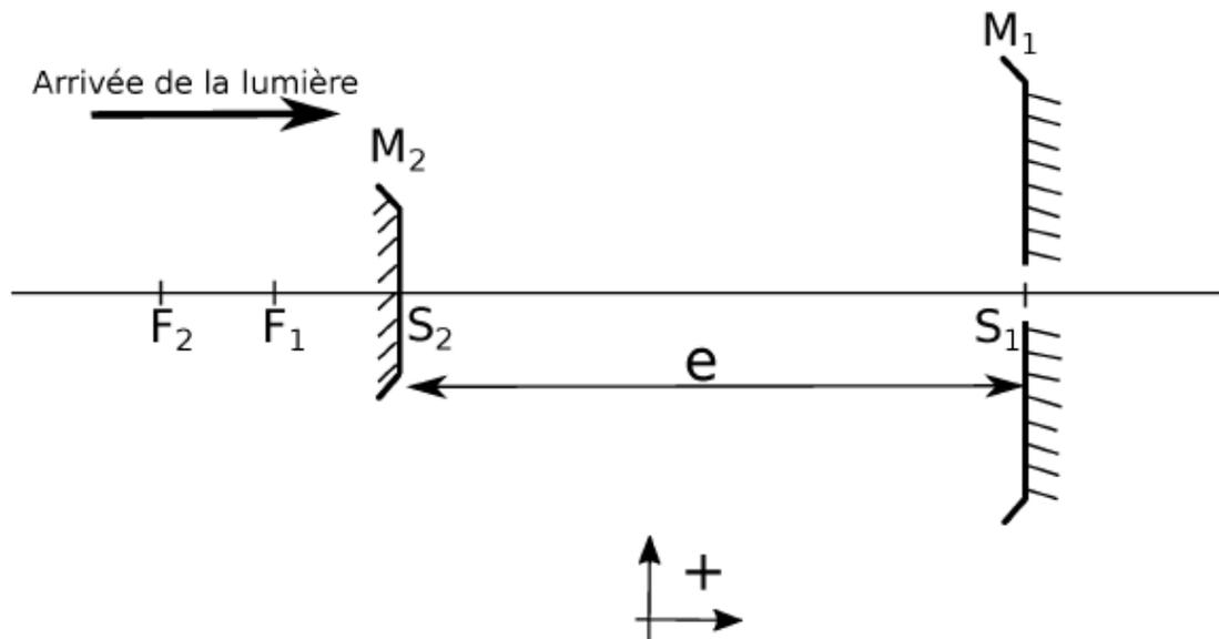
Figure 3 : Télescope « Cassegrain ». Le foyer  $F_1$  est situé entre  $S_2$  et  $F_2$ .
