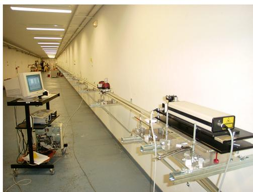
Le laboratoire GeF possède [un banc d'étalonnage](#) par interférométrie laser de 51 mètres, automatisé et équipé de capteurs de pression d'humidité et de température, destiné à vérifier l'exactitude de distancemètres électro-optiques.
