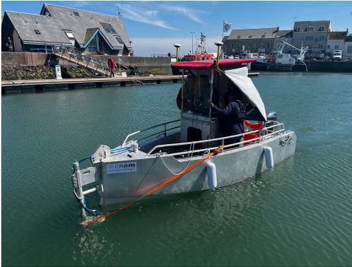
**La vedette du GeF instrumentée avec des équipements performants** permet la réalisation de mesures bathymétriques devenues indispensables pour la compréhension du fonctionnement morphologique des cours d'eau.
