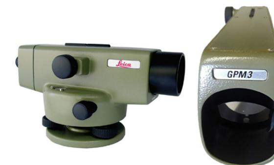
niveau + micromètre
