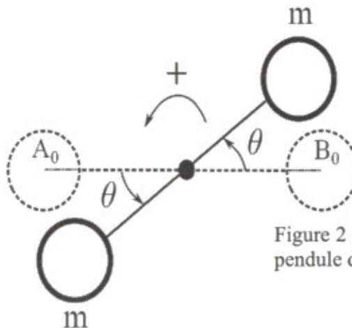
Figure 2 : vue de dessus du pendule de torsion
