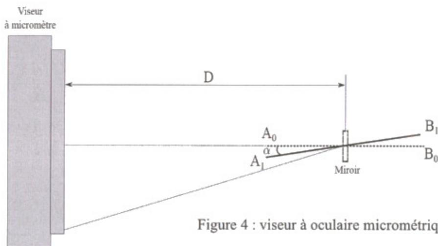
Figure 4 : viseur à oculaire micrométrique
