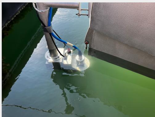
Le système multifaisceau est centré sur un capteur compact, R2Sonic 2020, qui permet de réaliser des mesures haute résolution dans les très petits fonds (< 30 m) et peut se coupler à différents capteurs de mesures géophysiques (gravimètre mobile, Lidar, etc.) développés par ailleurs.
